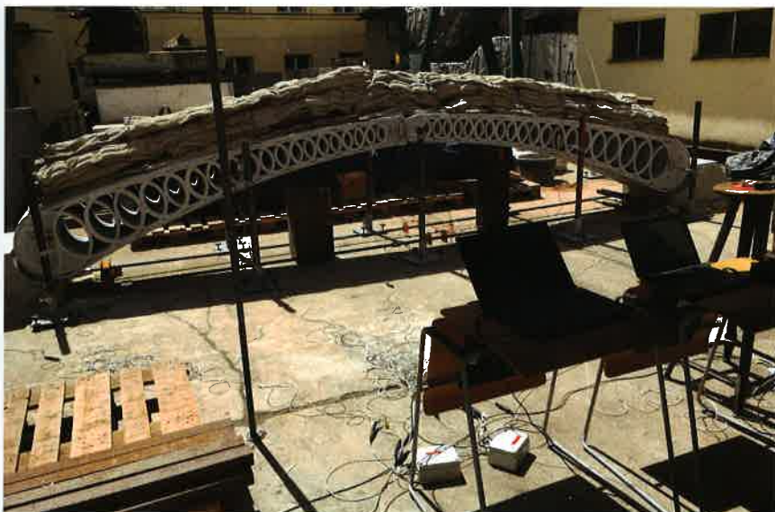
1 Podélný pohled na lávku osazenou na výpusti rybníka v Solopiscích 2 Tvarování tiskové dráhy 3 Tisk lávky v Kloknerově ústavu trval cca 6 h 4 Zatěžovací zkouška lávky 5 Vizualizace osazení lávky – příčný práh výpusti rybníka nahradil spodní táhlo trojúhelníkové konstrukce 6 Finální návrh 3D tištěné lávky 7 Osazování lávky na hrázi rybníka
